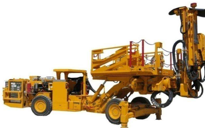
Obrázek 11: Plošina na osazování kotev a ocelových sítí
