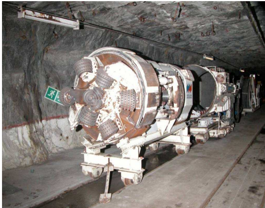
Obrázek 24: Velkoprofilové vrtací zařízení v remíze
